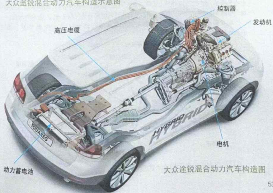
大众途锐混合动力汽车构造示意图
